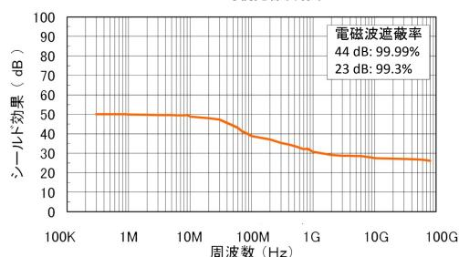
EMIシールド: △35dB (携帯電話基地局、PHS アンテナ、無線LANなど からのマイクロ波を遮蔽 (35 dB @ 300 MHz)
